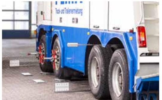
Kit de actualización para alineación de semirremolques y remolques.
