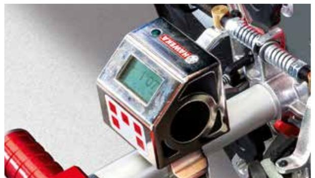
*Inclinómetro (medidor del ángulo de inclinación)*
