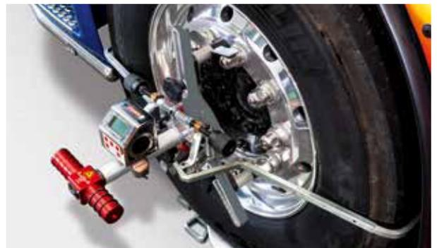
Tête à laser et capteur d'angle d'inclinaison
