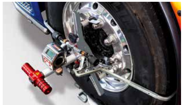
Testa laser e misuratore dell'angolo di inclinazione
