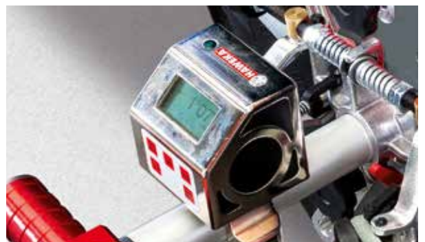
Inclinometro (misuratore dell'angolo di inclinazione)
