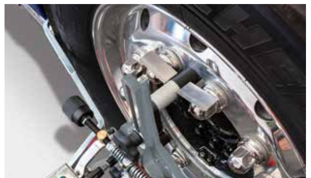
Morsetti di fissaggio per cerchioni in alluminio
