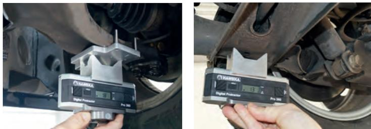
Ejemplos de aplicación (adaptador de medición ③ y adaptador de corona ①)
