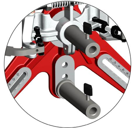
Colocación rápida y simple de un pivote más en el soporte, para alineador de ruedas para vehículos de altura sobre el suelo rebajada.
