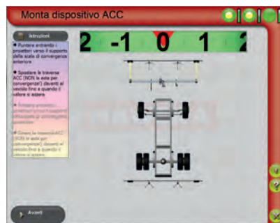
Allineamento della traversa di misura
