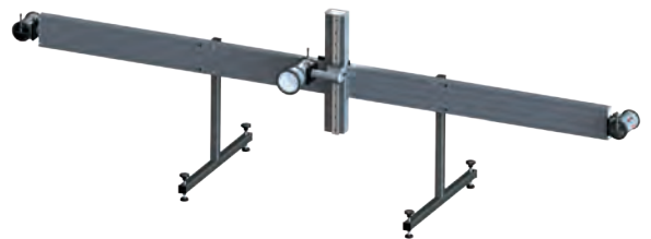
Trawersa pomiarowa z kamerą SAD4000
