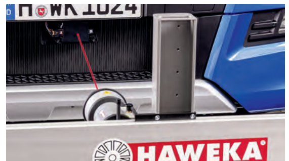
Regulacja kamery SAD4000 na czujniku ACC
