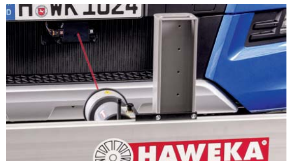
Настройка камеры SAD4000 на ACC-датчик
