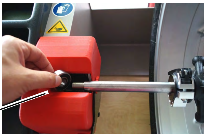
Вид спереди - слева, плавающий подшипник вала
