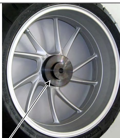
Установка соответствующего центрирующего диска
