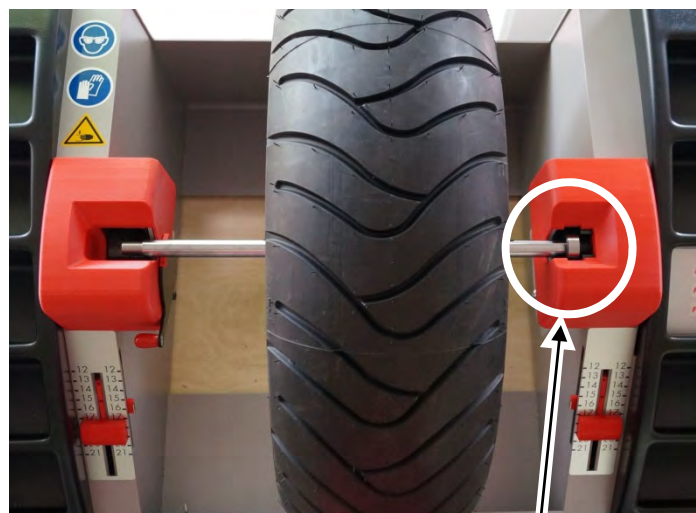
Вид спереди - справа, фиксированный подшипник вала
