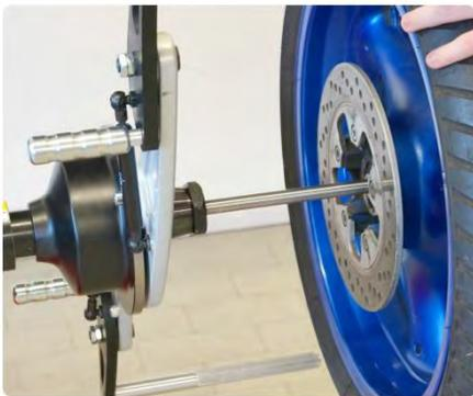
Choisissez le sens de montage de telle manière que la plus grande longueur de la roue (ici le côté avec le disque de frein) soit dirigé vers l'aile de l'entraîneur.
