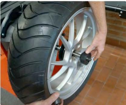
Placer l'élément de pression sur le côté extérieur de la jante.
