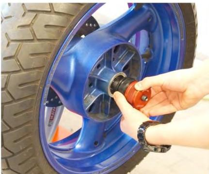
Le **QuickFix** est poussé sur l'arbre et pressé fermement sur la roue. L'ensemble de l'unité de centrage est ensuite fixé en tournant la bague en plastique noire du QuickFix.
