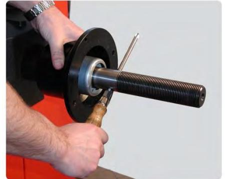
Montage de l'aile de l'entraîneur ProBike sur le corps principal
