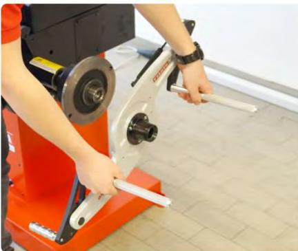
Enfilez l'aile de l'entraîneur ProBike sur le corps principal et guider les vis de fixation par l'arrière dans le corps principal. Puis serrez les vis avec la clé hexagonale à l'identique.
