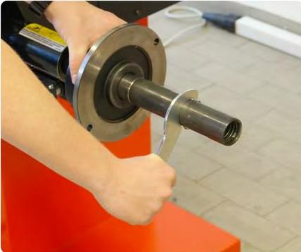
Actionne le frein au pied (si disponible) et desserrez l'arbre central du corps principal avec un outil approprié (clé à broche ou tournevis) selon le type de machine.
