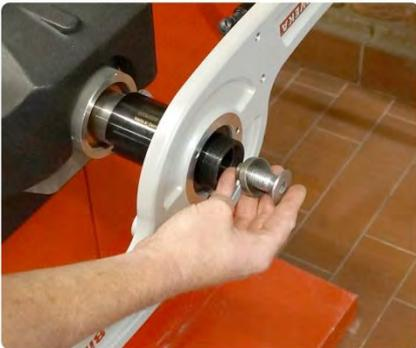
Placez l'aile de l'entraîneur ProBike sur l'extrémité de conique de l'arbre et vissez avec la vis à six pans creux incl. rondelle (rondelle à portée conique) sur le raccord de la machine.
