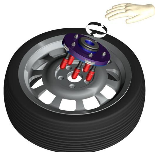
Das Feststellen des Lochkreises muss erfolgen, da sich sonst der erforderliche Lochkreisdurchmesser beim Montieren an der Wuchtmaschine verstellen kann.
