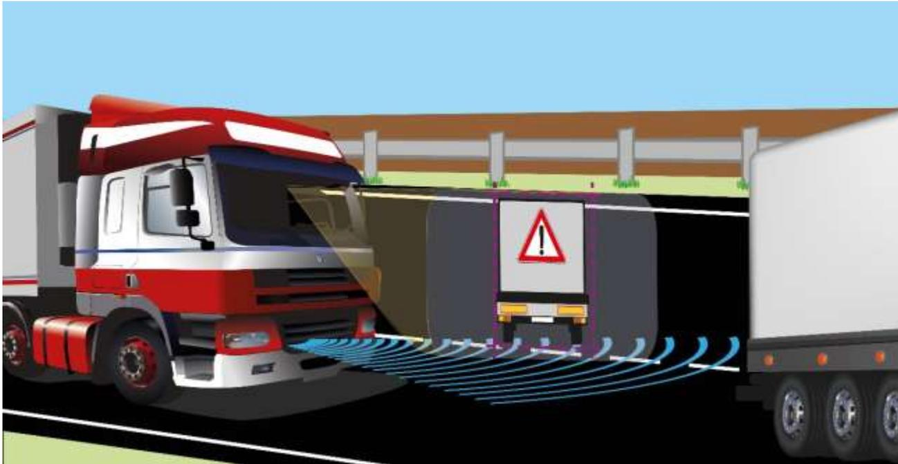
Der Abstandsregeltempomat ACC hält eine für das Fahrzeug eingestellte Geschwindigkeit ein. Dabei wird aber auch ein bestimmter, eingestellter Abstand zum vorausfahrenden Fahrzeug eingehalten. Dieser Abstand wird vom System nicht unterschritten.
