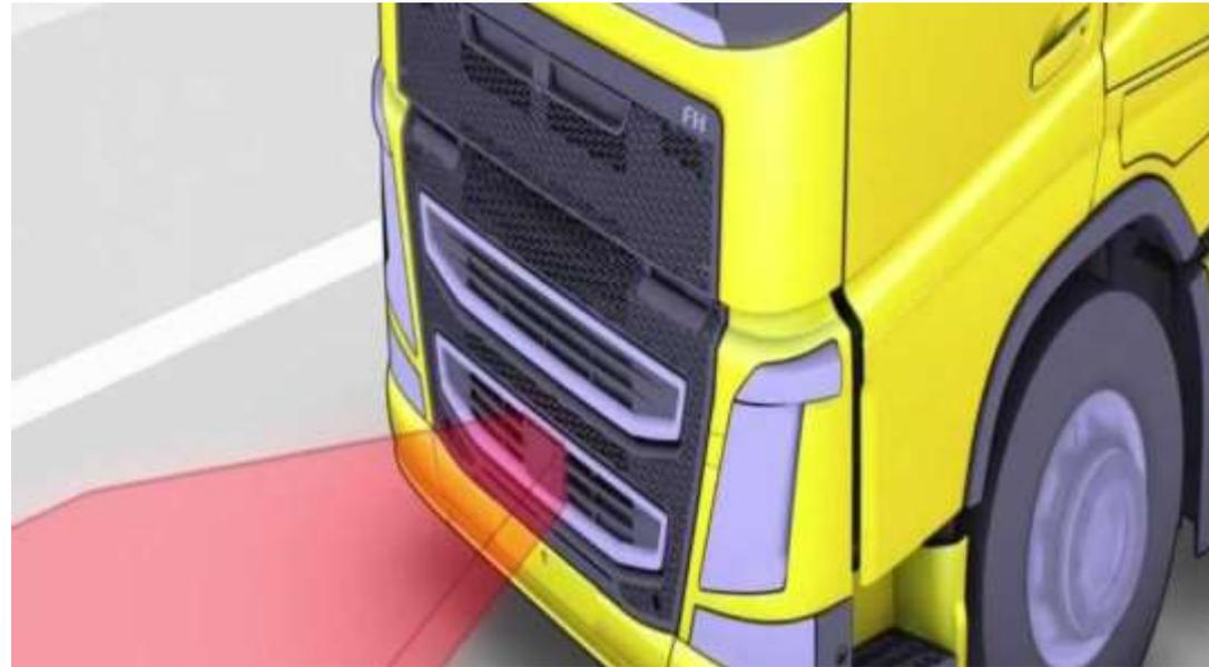
Das Radar arbeitet mit Hilfe des Dopplereffekts. Kennt man die Laufzeit von Radarwellen in der Luft kann man aufgrund von Laufzeitunterschieden der gesendeten und empfangenen Wellen die Entfernung zu einem Objekt ausrechnen.
