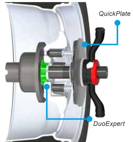
Bloccaggio di una ruota **con QuickPlate**. Con i giusti attrezzi di centraggio e serraggio si garantisce un perfetto risultato di equilibratura.
