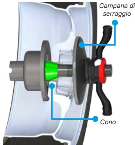
Bloccaggio di una ruota **senza QuickPlate**. Il cerchione può inclinarsi, il risultato di equilibratura viene alterato.
